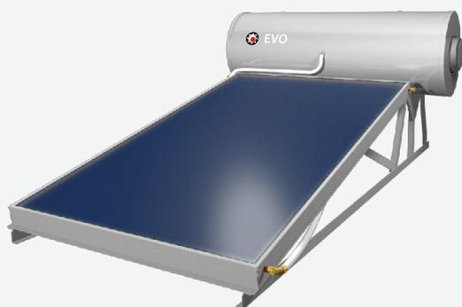
Il kit solare **CMG EVO** è nato per soddisfare le esigenze congiunte di economicità e funzionalità. Il sistema funziona tramite un circuito che permette al liquido termovettore caldo, proveniente dalla piastra assorbente, di raggiungere la parte mediana del serbatoio, rendendo possibile un più rapido riscaldamento dell'acqua presente nella parte superiore del boiler e una migliore stratificazione del calore.
